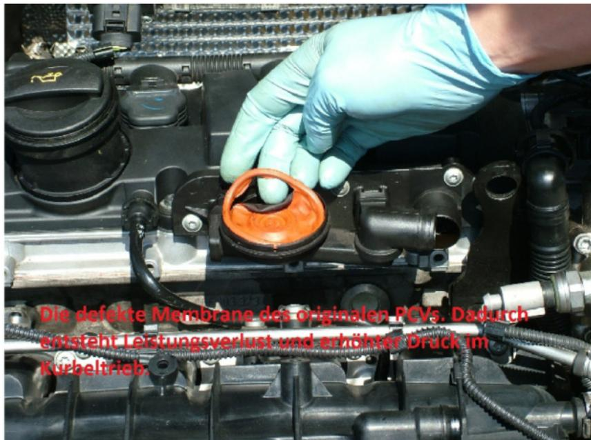
Die defekte Membrane des originalen PCVs. Dadurch entsteht Leistungsverlust und erhöhter Druck im Kurbeltrieb.
